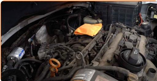
6 Desconecte el manguito de ventilación del cárter del tubo de llenado de aceite.
