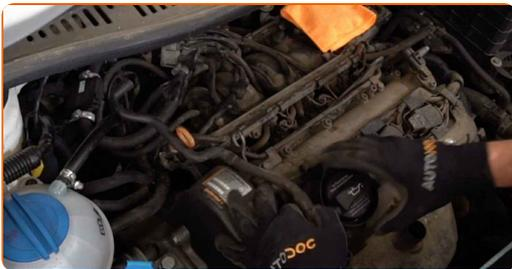
7 Desatornille el tubo de llenado de aceite. Retire el tubo de llenado de aceite.
