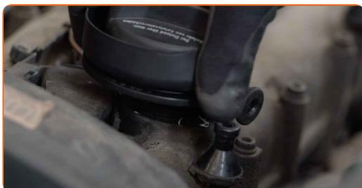
20 Fije el manguito de ventilación del cárter al tubo de llenado de aceite.
