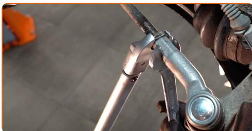
**18** Atornille la tuerca de sujeción que conecta el extremo de la barra de acoplamiento a la mangueta de dirección. Use un vaso de impacto del n.º 17. Utilice una llave de trinquete.
