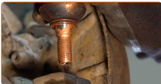
**15** Conecte la punta de la barra de dirección al muñón de dirección.
