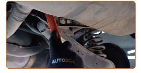
Haga una marca en el perno de ajuste de la inclinación.
