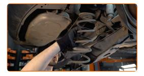
Instale el resorte helicoidal junto con los soportes de montaje de goma en los asientos de montaje. Use una palanca.
