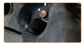
Atornille la sujeción que une el brazo de control al subchasis. Use un vaso de impacto del n.º 18. Utilice una llave de trinquete.
