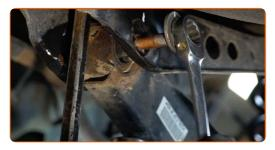
Ajuste la posición del perno de alineación según la marca.
