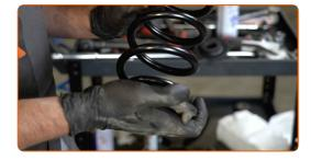
Instale el resorte helicoidal junto con los soportes de montaje de goma en los asientos de montaje.
