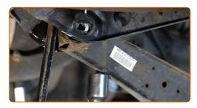
21 Instale el perno de sujeción.
