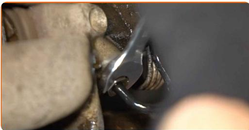
**9** Afloje la sujeción que conecta el tubo de freno a la pinza de freno. Usa una llave mixta del n.º 11.
