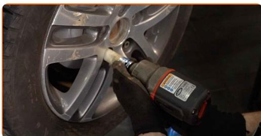
**41** Baje el automóvil y, manteniendo el orden cruzado, apriete los pernos de fijación de las ruedas. Utilice una llave dinamométrica. Apriételo a un par de 120 Nm.
