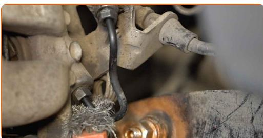
**8** Afloje la sujeción que conecta el tubo de freno al latiguillo de freno. Usa una llave mixta del n.º 11.
