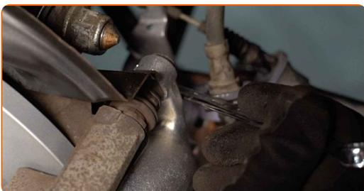
**31** Afloje el tornillo de purgado de frenos. Usa una llave mixta del n.º 11.
