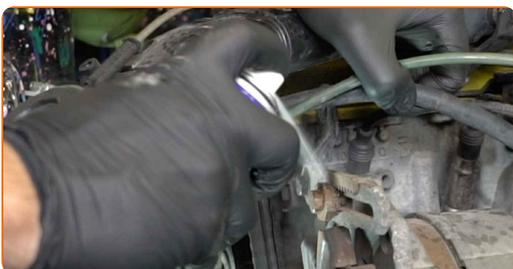
**14** Afloje las sujeciones del alternador. Usa una llave mixta del n.º 13.
