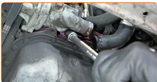
**9** Retire la carcasa del termostato.
