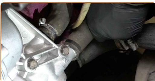
**28** Asegure la abrazadera de la manguera de refrigerante. Use un vaso de impacto del n.º 7. Utilice una llave de trinquete.
