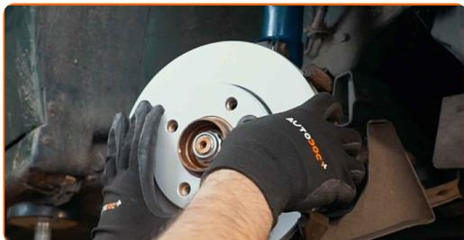
**62** Apriete la fijación del disco de freno. Utilice Torx T27. Utilice una llave dinamométrica. Apriételo a un par de 9 Nm.
