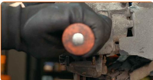
**9** Limpie las sujeciones de la pinza del freno. Use un cepillo de alambre. Use el aerosol WD-40.
