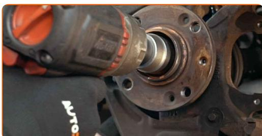
**59** Limpie el cubo. Use un cepillo de alambre. Utilice un spray de limpieza multiuso. Trate la superficie de contacto. Use grasa de cobre.
