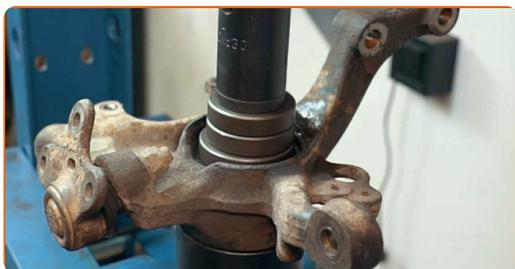
**36** Limpie el asiento de montaje del cojinete del cubo (buje). Use un cepillo de alambre. Use el aerosol WD-40.
