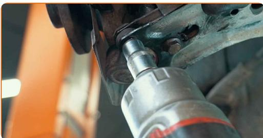
**49** Instale el perno de sujeción.
