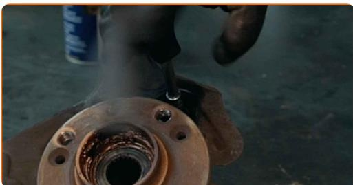
**29** Retire la cubierta del disco de freno.
