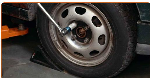
**4** Afloje la sujeción del eje de transmisión. Use un vaso de impacto del n.º 30. Utilice una llave giramachos.
