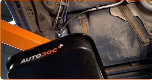
6 Apriete los clips y separe las líneas de suministro de combustible de la carcasa del filtro de aceite. Utilice un destornillador plano.
