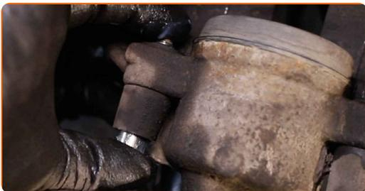
**19** Trate las pastillas de freno en el área donde su superficie entra en contacto con el soporte de la pinza de freno. Use pasta antichirridos.
