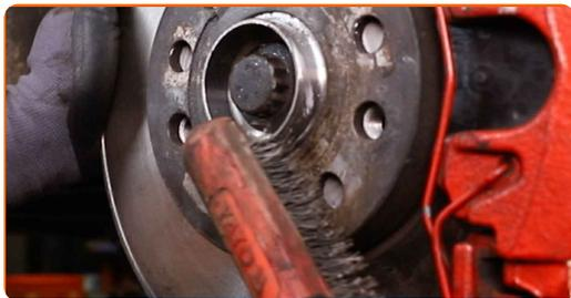
**26** Trate la superficie donde el disco del freno entra en contacto con la llanta de la rueda. Utilice grasa cerámica.
