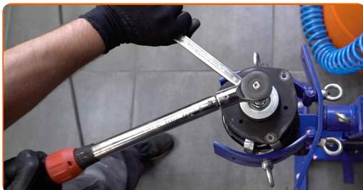
Sustitución: copelas del amortiguador - VW Jetta Mk5 (1K). Consejo de AUTODOC:
