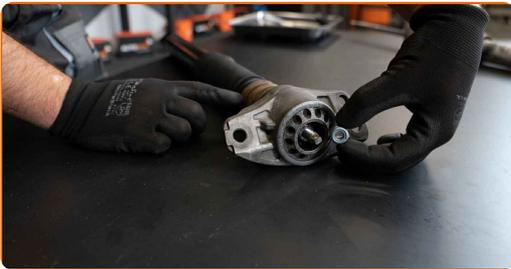
**17** Atornille la fijación superior de la varilla del amortiguador. Usa una llave mixta del n.º 16. Use una llave ajustable. Utilice una llave dinamométrica. Apriételo a un par de 25 Nm.
