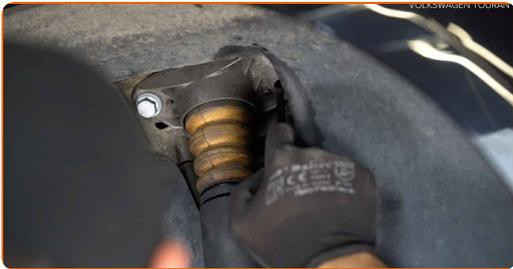
22 Atornille la fijación de la cazoleta del amortiguador. ¡Importante! Asegúrese de utilizar elementos de sujeción nuevos. Use un vaso de impacto del n.º 16. Utilice una llave dinamométrica. Apriételo a un par de 50 Nm.+45°
