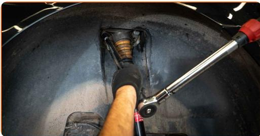
23 Apriete la fijación inferior del amortiguador. Use un vaso de impacto del n.º 21. Utilice una llave dinamométrica. Apriételo a un par de 180 Nm.
