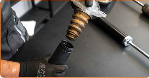
**16** Instale el soporte de montaje superior del amortiguador.
