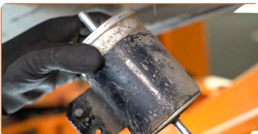
Sustitución: filtro de combustible - VW LT 28-46 II Camión de plataforma / Chasis (2DC, 2DF, 2DG, 2DL, 2DM). Los profesionales recomiendan:
