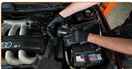
11 Atornille los tornillos de sujeción de la cubierta del filtro de aire (4 piezas). Utilice un destornillador Phillips.
