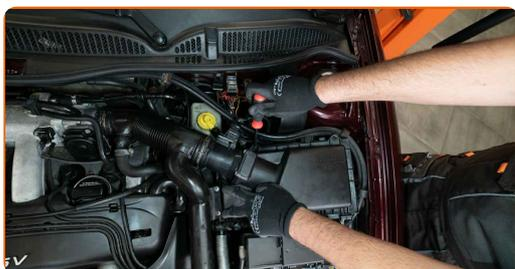
**4** Desenchufe el conector del sensor de flujo de aire. Suelte la collera y quite la manga del conducto de admisión de aire desde la carcasa del filtro. Branchez le connecteur du débitmètre d'air.
