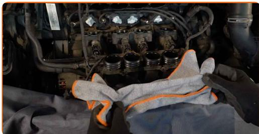
**24** Retire la junta del colector de admisión. Utilice un destornillador plano.
