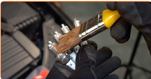
**18** Instale las nuevas bujías en sus asientos de montaje. Use el vaso de bujía # 16.
