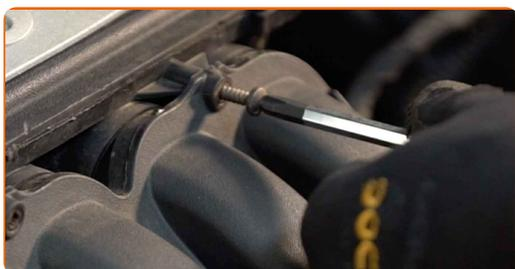
**28** Apriete las sujeciones del colector de admisión. Use Vaso HEX No. H6. Use un vaso de impacto del n.º 13. Utilice una llave de trinquete.
