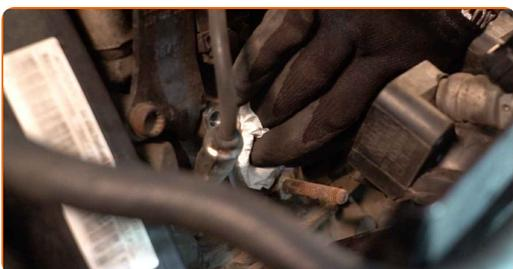
**13** Retire los conectores del cable de bujías de los pozos de la bujía.
