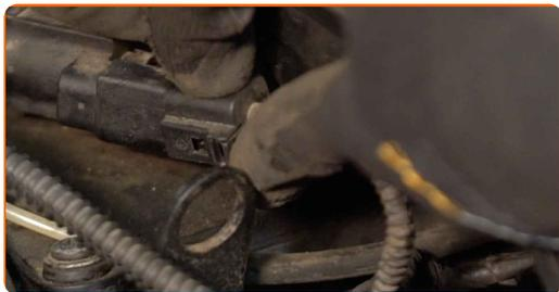
**30** Conecte el tubo de vacío.
