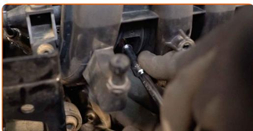
**29** Conecte el sensor de vacío.
