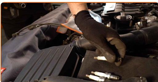
**17** Aplique una capa fina de un lubricante antigripado especial de alta temperatura a las roscas de las nuevas bujías.
