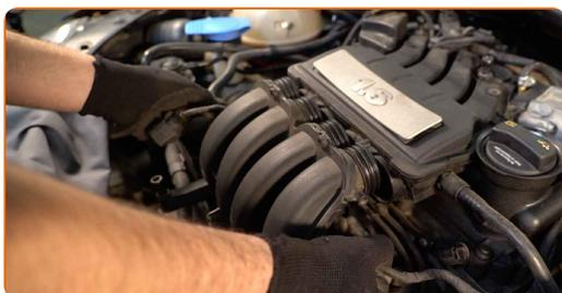
**27** Apriete las sujeciones del colector de admisión. Utilice un destornillador Phillips.
