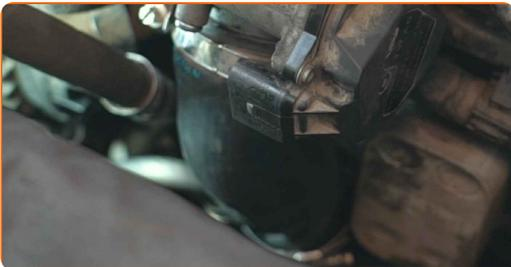
60 Atornille la sujeción del tubo de la varilla de nivel. Usa una llave mixta del n.º 10.
