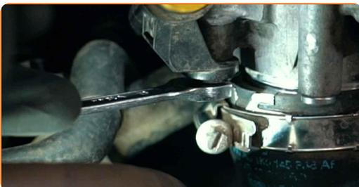
61 Asegure la sujeción del conducto de admisión de aire. Use un vaso de impacto del n.º 7. Utilice una llave de trinquete.
