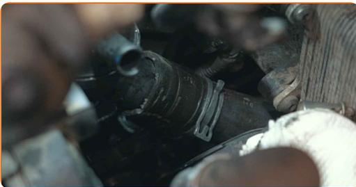
45 Una la abrazadera de la manguera superior de refrigerante. Utilice unos alicates de punta de aguja.
