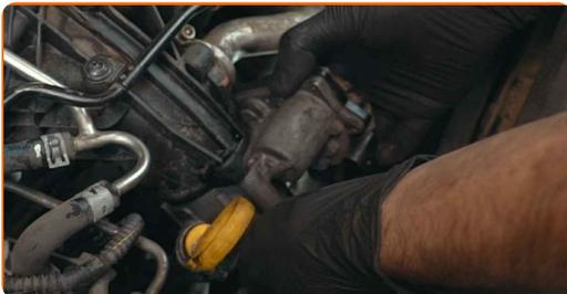
56 Apriete las sujeciones del cuerpo de mariposa al colector de admisión de aire. Utilice Torx T27. Utilice una llave dinamométrica. Apriételo a un par de 14 Nm.
