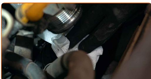
11 Desatornille las sujeciones que conectan la válvula de mariposa al colector de admisión. Utilice Torx T27. Utilice una llave de trinquete.
