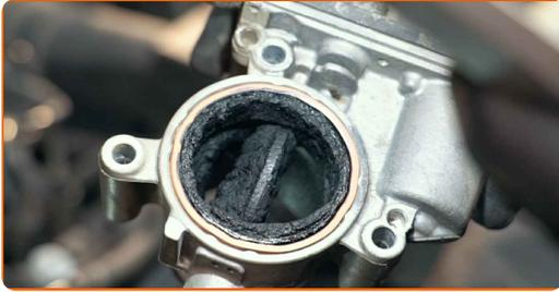
Sustitución: termostato refrigerante - VW Multivan T6 (SGF, SGM, SGN). Los expertos de AUTODOC recomiendan:
