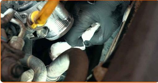
58 Limpie el asiento de montaje de la manguera de admisión de aire. Utilice un spray de limpieza multiuso.
