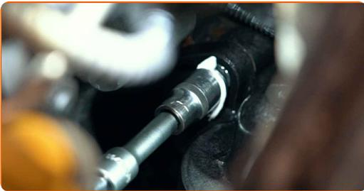
43 Apriete las sujeciones de la carcasa del termostato. Use un vaso de impacto del n.º 10. Utilice una llave dinamométrica. Apriételo a un par de 9 Nm.
