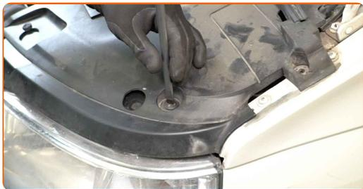
**9** Desenrosque las sujeciones del panel de la cubierta de los bajos. Use un vaso de impacto del n.º 13. Utilice una llave de trinquete.
