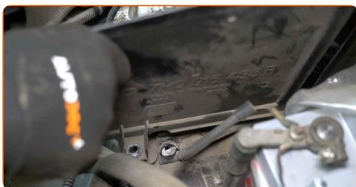
**11** Desenrosque el soporte del filtro de combustible. Use un vaso de impacto del n.º 10. Utilice una llave de trinquete.
