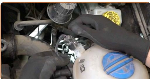
**4** Desatornille las sujeciones del depósito de refrigerante. Utilice un destornillador Phillips.
