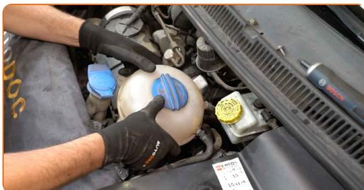
**26** Atornille las sujeciones del depósito de refrigerante. Utilice un destornillador Phillips.
