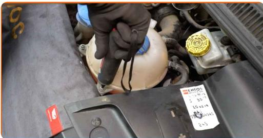
**27** Una el conector del vaso de expansión de refrigerante.
