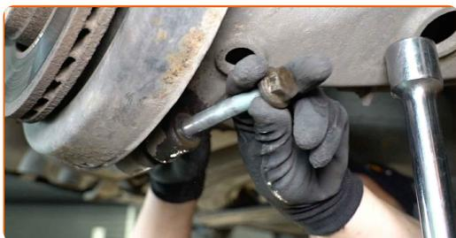
**10** Destornille la fijación superior del amortiguador. Use un vaso de impacto del n.º 18. Utilice una llave de trinquete.
