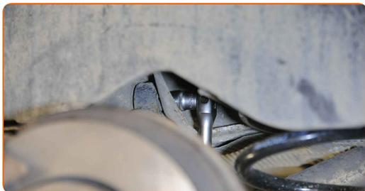
**11** Retire el perno de sujeción.
