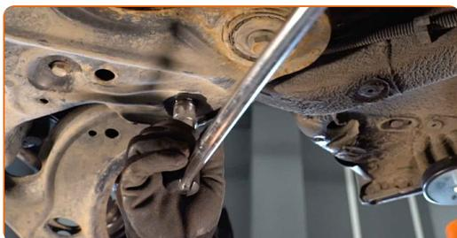
**11** Retire la sujeción trasera del brazo de control.
