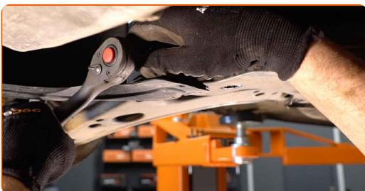
**13** Retire la sujeción delantera del brazo de control.
