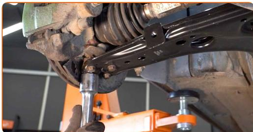
**22** Apriete la sujeción delantera que conecta el brazo de control al subchasis. Use un vaso de impacto del n.º 18. Utilice una llave dinamométrica. Apriételo a un par de 70 Nm.+90°
