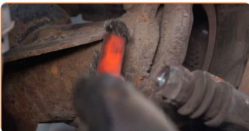
**14** Desenrosque las sujeciones del soporte de la pinza de freno. Use Vaso HEX No. H8. Utilice una llave de trinquete.
