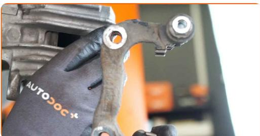
**17** Limpie la sujeción del disco de freno. Use un cepillo de alambre. Use el aerosol WD-40.
