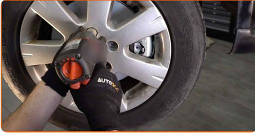
23 Baje el automóvil y, manteniendo el orden cruzado, apriete los pernos de fijación de las ruedas. Utilice una llave dinamométrica. Apriételo a un par de 120 Nm.
