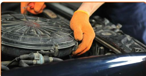
**5** Retire la cubierta del filtro de aire.
