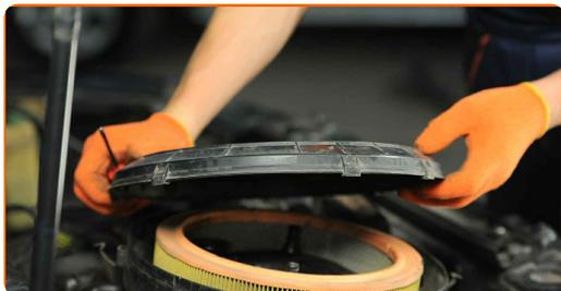
**6** Saque de la carcasa del filtro el elemento filtrante de recambio.
