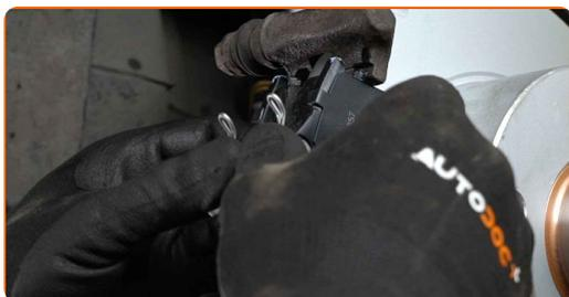
**17** Instale el cáliper de freno y fíjelo. Use una llave mixta del n.º 13. Use una llave mixta del n.º 15. Utilice una llave dinamométrica. Apriételo a un par de 35 Nm.
