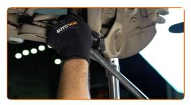
9 Retire el perno de sujeción.
