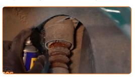
Destornille la fijación superior del amortiguador. Use un vaso de impacto del n.º 13. Utilice una llave de trinquete.
