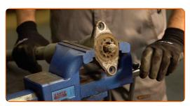
Limpie la sujeción del vástago del amortiguador. Use un cepillo de alambre. Use el aerosol WD-40.
