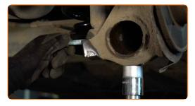
Retire el soporte por debajo de la viga trasera.
