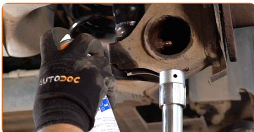
**24** Retire el soporte por debajo de la viga trasera.
