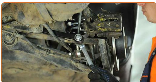
**18** Atornille la sujeción que conecta el brazo de control al subchasis. Use una llave mixta del n.º 19. Use un vaso de impacto del n.º 19. Utilice una llave de trinquete.
