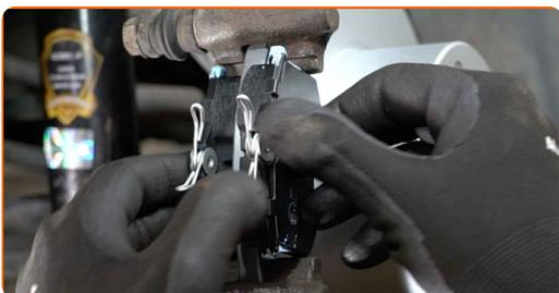
**34** Establezcan el soporte de freno y lo fijen. Usa una llave mixta del n.º 15. Use un vaso de impacto del n.º 13. Utilice una llave dinamométrica. Apriételo a un par de 35 Nm.
