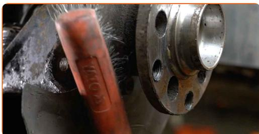
**18** Desenrosque los pernos del cubo de rueda. Use Vaso HEX No. H8. Utilice un destornillador de impacto. Utilice una llave de trinquete.
