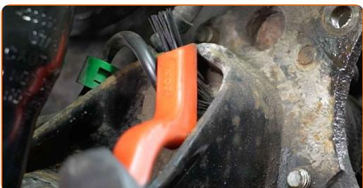
**15** Separe la sujeción del sensor ABS. Utilice un destornillador plano.
