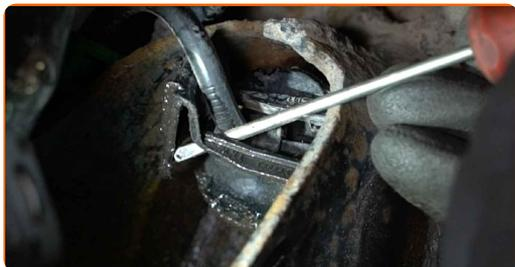
**16** Desconecte el sensor ABS. Utilice unas tenazas.
