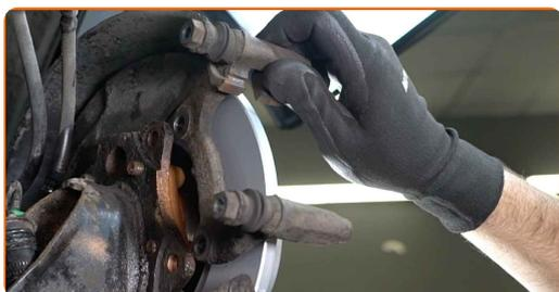
**30** Apriete la fijación de la pinza del cáliper de freno. Use Vaso HEX No. H8. Utilice una llave dinamométrica. Apriételo a un par de 95 Nm.
