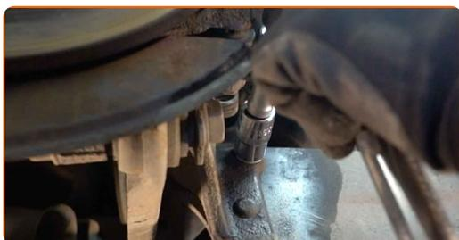
**12** Instale la fijación de la varilla a la palanca y apriétela. Usa una llave mixta del n.º 14. Utilice las puntas XZN #6. Use un vaso de impacto del n.º 15. Utilice una llave dinamométrica. Apriételo a un par de 45 Nm.
