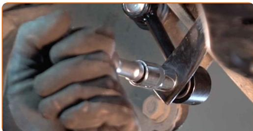
**13** Trate todas las juntas de la bieleta o enlace estabilizador. Use grasa de cobre.
