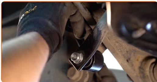
**11** Apriete la sujeción que conecta la bieleta a la barra estabilizadora. Usa una llave mixta del n.º 14. Utilice las puntas XZN #6. Use un vaso de impacto del n.º 15. Utilice una llave dinamométrica. Apriételo a un par de 45 Nm.
