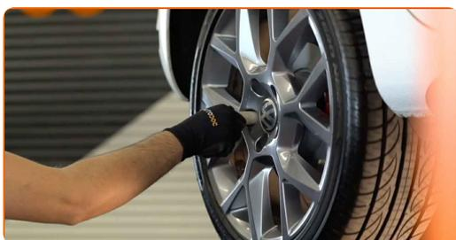
**32** Baje el automóvil y, manteniendo el orden cruzado, apriete los pernos de fijación de las ruedas. Utilice una llave dinamométrica. Apriételo a un par de 120 Nm.
