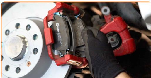
**28** Establezcan el soporte de freno y lo fijen. Usa una llave mixta del n.º 13. Usa una llave mixta del n.º 19. Use un vaso de impacto del n.º 13. Utilice una llave dinamométrica. Apriételo a un par de 35 Nm.
