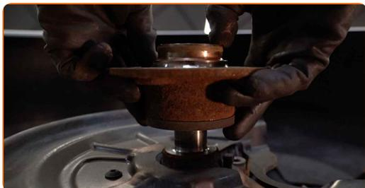
**18** Limpie la parte guía del muñón del eje. Use el aerosol WD-40.
