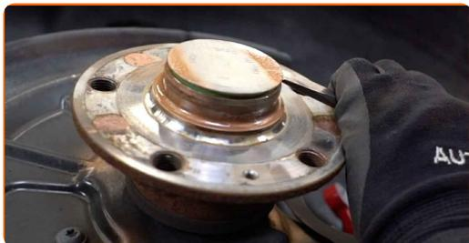
**16** Destornille la fijación del cubo de la rueda. Utilice las puntas XZN #18. Utilice una llave giramachos.
