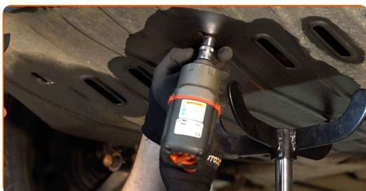
**5** Retire la cubierta del cárter de aceite.
