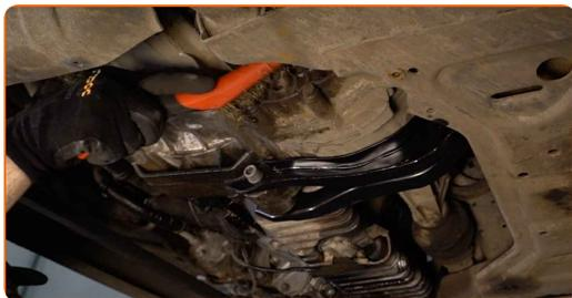
**7** Coloque un contenedor para el aceite de desecho con al menos 3 l de capacidad debajo del orificio de drenaje.
