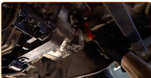
**6.2** Limpie el área del orificio de drenaje de la bandeja de aceite. Use un cepillo de alambre. Use el aerosol WD-40.
