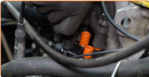
Sustitución: cables de bujías - VW Passat B2 Hatchback (32B). Los expertos de AUTODOC recomiendan:
