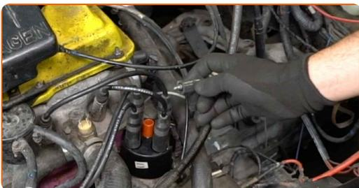
Sustitución: cables de bujías - VW Passat B2 Hatchback (32B). Consejo:
