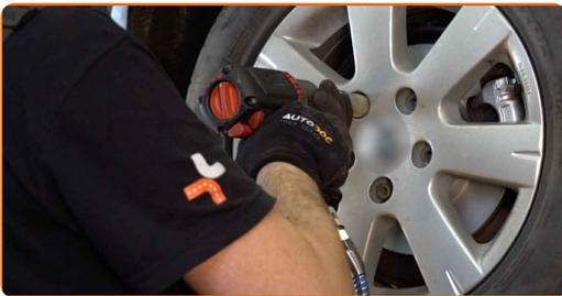
21 Baje el automóvil y, manteniendo el orden cruzado, apriete los pernos de fijación de las ruedas. Utilice una llave dinamométrica. Apriételo a un par de 120 Nm.
