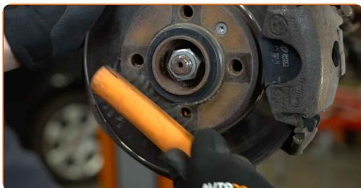
**44** Trate la superficie donde el disco del freno entra en contacto con la llanta de la rueda. Use grasa de cobre.
