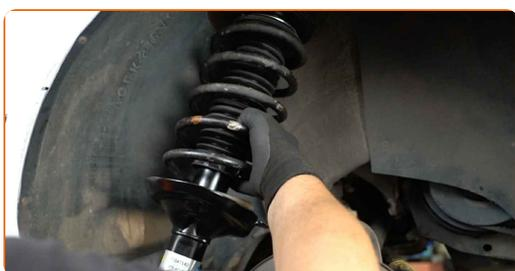
**32** Atornillen la fijación superior de la cazoleta de la pata amortiguadora. No lo apriete.
