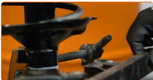
**29** Retire el puntal amortiguador que está montado.
