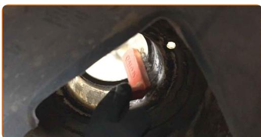
**31** Instale la pata amortiguadora en el arco de la rueda.
