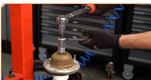
Sustitución: amortiguador telescópico - VW Passat B5 Berlina (3B2).
