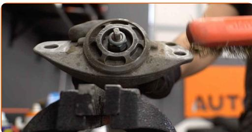
**14** Limpie la sujeción del vástago del amortiguador. Use un cepillo de alambre. Use el aerosol WD-40.
