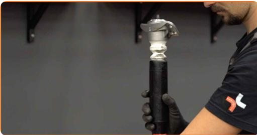
**18** Fije la cazoleta del amortiguador. Usa una llave mixta del n.º 14. Use un vaso de impacto del n.º 14. Utilice una llave dinamométrica. Apriételo a un par de 25 Nm.
