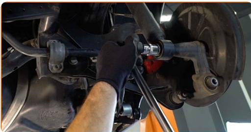
**11** Destornille la fijación superior del amortiguador. Use un vaso de impacto del n.º 15. Utilice una llave de trinquete.
