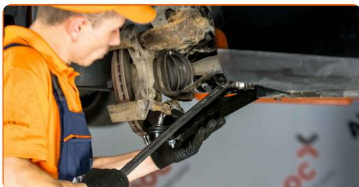
**15** Desconecte el brazo inferior del muñón de dirección. Utilice un martillo.
