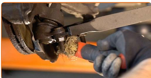
**14.1** Destornille la fijación del soporte esférico del muñón de dirección.
