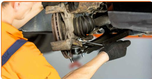
**50** Apriete la fijación del soporte esférico. Use una llave mixta del n.º 19. Utilice una llave dinamométrica. Apriételo a un par de 60 Nm.
