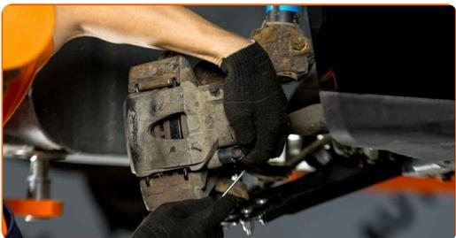
**11.1** Destornille la fijación del cáliper de freno.
