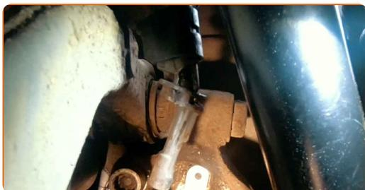
9 Suelte el conector del sensor ABS.
