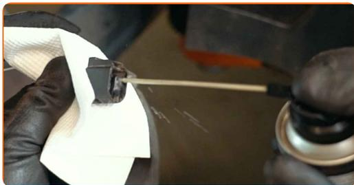
11 Limpie el asiento de montaje del sensor ABS. Use un cepillo de alambre. Use el aerosol WD-40.
