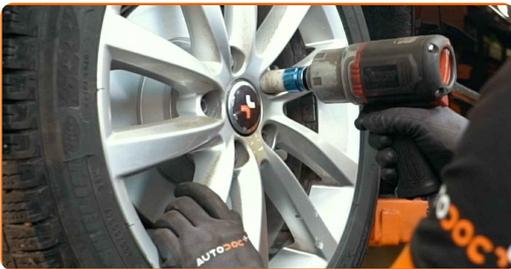
21 Baje el automóvil y, manteniendo el orden cruzado, apriete los pernos de fijación de las ruedas. Utilice una llave de impacto para llanta # 17. Utilice una llave dinamométrica. Apriételo a un par de 120 Nm.
