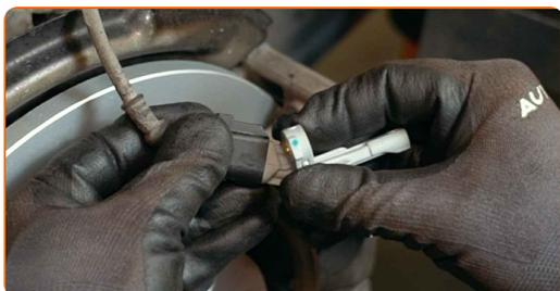
13 Trate la sujeción del sensor ABS. Utilice una grasa multiuso. Use una palanca.
