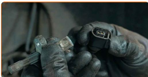
10 Trate el conector del sensor ABS. Utilice grasa dieléctrica.
