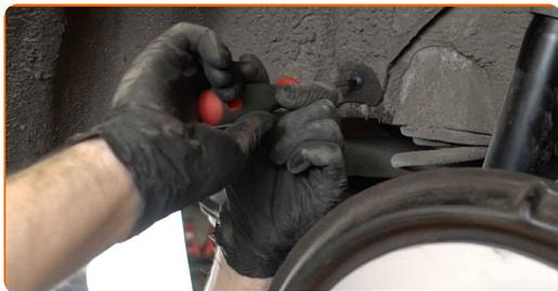
**37** Trate las sujeciones del amortiguador. Use grasa de cobre.
