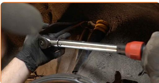
**32** Trate las sujeciones del amortiguador. Use grasa de cobre.
