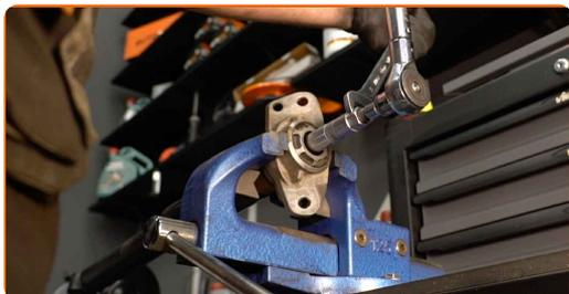
**23** Trate la sujeción de la varilla del amortiguador. Use grasa de cobre.
