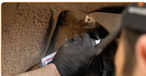
**27** Coloque el amortiguador en el arco de la rueda y fíjelo.
