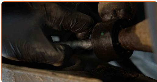
**13** Destornille la fijación superior del amortiguador. Use un vaso de impacto del n.º 16. Utilice una llave de trinquete.
