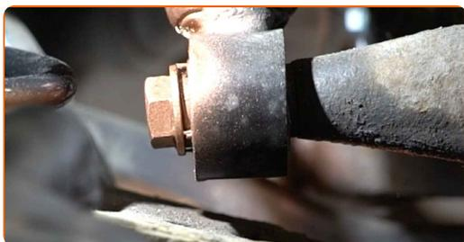
**38** Trate la superficie donde el disco del freno entra en contacto con la llanta de la rueda. Use grasa de cobre.
