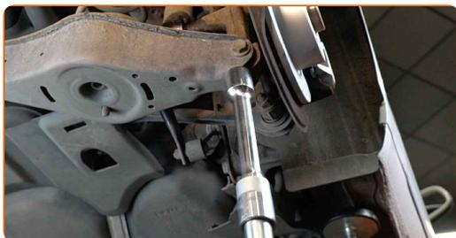
**12** Retire el perno de sujeción.
