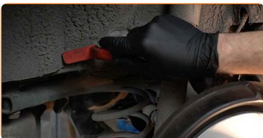
**7** Desatornille las sujeciones del protector de paso de rueda. Utilice Torx T27.
