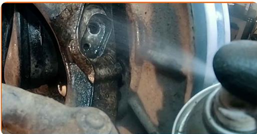
**11** Trate la sujeción del sensor ABS. Utilice una grasa multiuso. Utilice un destornillador plano.
