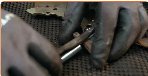
**22** Instale los resortes de parada superiores y el mecanismo de ajuste en las pastillas de freno nuevas. Utilice un destornillador plano.
