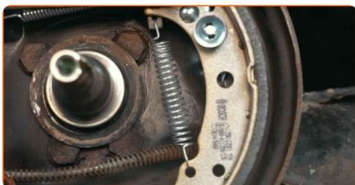
**28** Instale el muelle de retorno inferior. Use una palanca.
