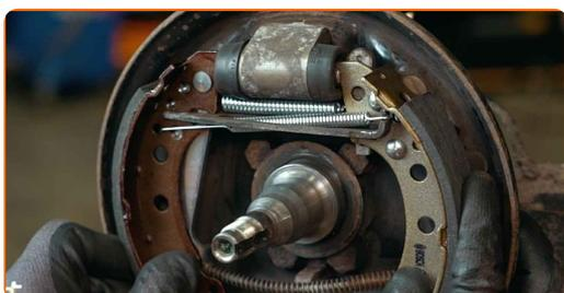
**26** Instale los retenedores de las zapatas del freno de tambor. Utilice un compresor de muelles de retención de la zapata de freno.
