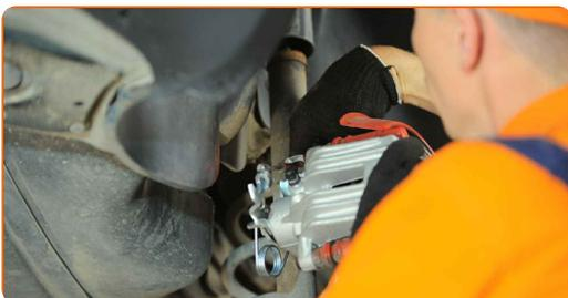
**21** Afloje el tornillo de purgado de frenos. Utilice una llave de tuerca abocinada #10.
