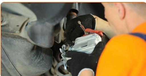
**20** Fije el cable del freno de estacionamiento mediante el clip de sujeción. Utilice un destornillador plano.
