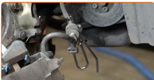
**10** Coloque un recipiente por debajo para recoger el líquido de frenos.
