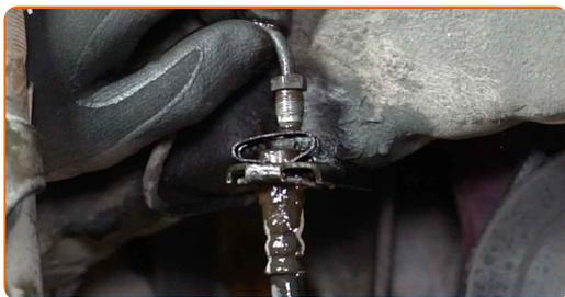
**15** Retire la abrazadera de la manguera del freno.
