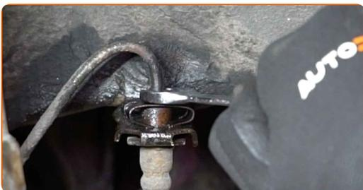
**14** Desatornille el tubo de freno del latiguillo de freno.
