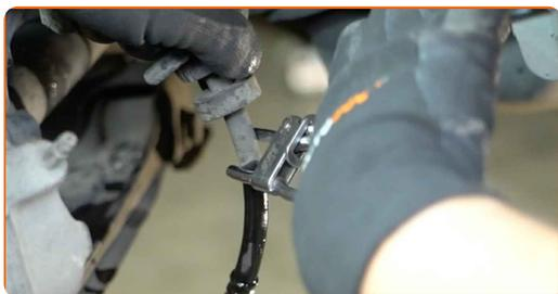
**16** Destornille el latiguillo de freno del cáliper de freno.
