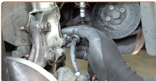
**23** Limpie la suciedad del perno del latiguillo de freno. Use un limpiador de frenos.
