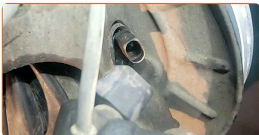
**7** Limpie la sujeción del sensor del ABS. Use un cepillo de alambre. Use el aerosol WD-40.
