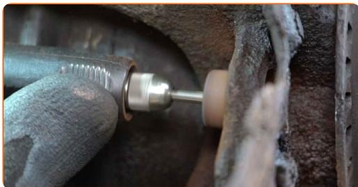
**19** Trate la sujeción del sensor ABS. Utilice una grasa multiuso.
