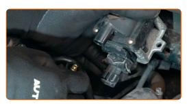
Sustitución: bobina de encendido - VW PASSAT Variant (3A5, 35I). AUTODOC recomienda:
