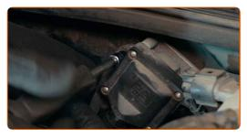
Retire la bobina de encendido.
