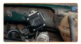
Apriete la atadura de la bobina del encendido. Use un vaso de impacto del n.º 10. Utilice una llave dinamométrica. Apriételo a un par de 7 Nm.
