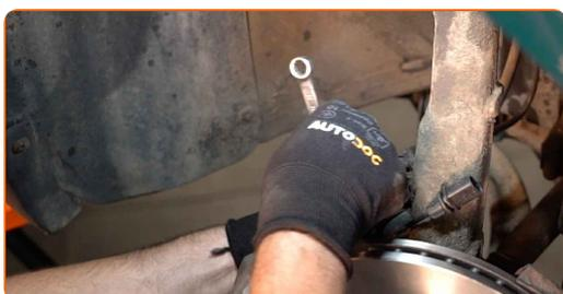
**28** Retire la abrazadera de la manguera del freno.
