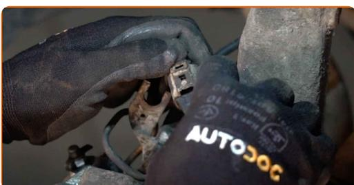
**30** Instale el resorte de fijación del cáliper de freno.
