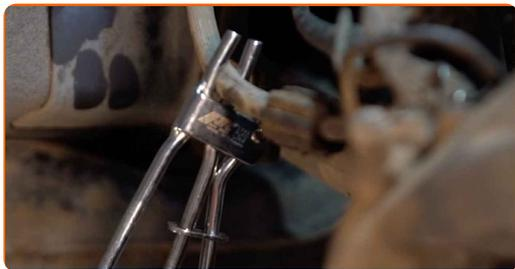
**9** Coloque un recipiente por debajo para recoger el líquido de frenos.
