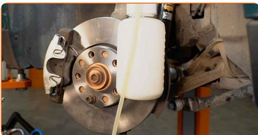
**32** Afloje el tornillo de purgado de frenos. Usa una llave mixta del n.º 10.
