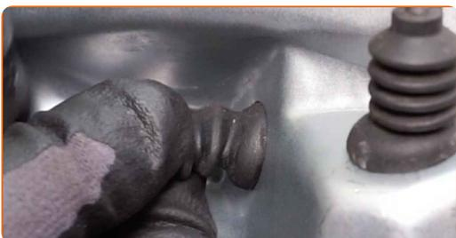
**43** Trate el conector del módulo del elevavinas eléctrico. Utilice grasa dieléctrica.
