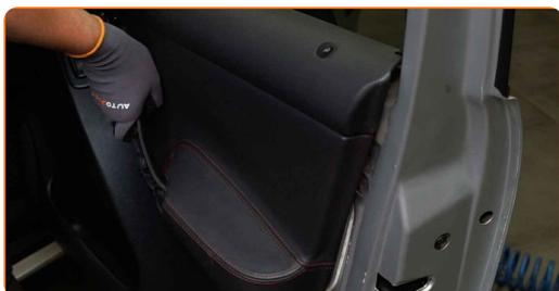
**65** Atornille las sujeciones del panel de la puerta. Utilice un destornillador Phillips.
