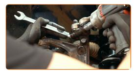
16 Retire el perno de sujeción.
