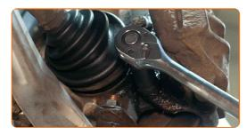
Retire la pinza del freno junto con su soporte.
