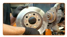
Retire el perno de sujeción. Use Vaso HEX No. H14. Utilice una llave de trinquete.
