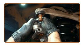
Instale el perno de sujeción.
