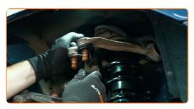
Separe el eje de transmisión de la mangueta de dirección.
