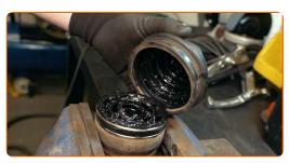
Retire el cojinete de la junta homocinética. Use una palanca.
