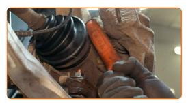
Destornille la fijación de la pinza del cáliper de freno. Use un vaso de impacto del n.º 17. Utilice una llave de trinquete. Utilice una llave giramachos.
