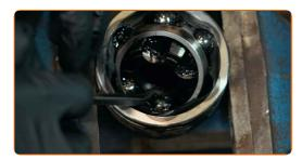
Limpie el asiento de montaje de la junta homocinética. Utilice un spray de limpieza multiuso.
