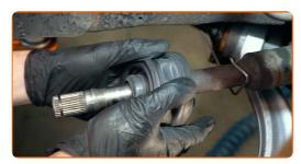
Instale el anillo de seguridad de la junta homocinética.
