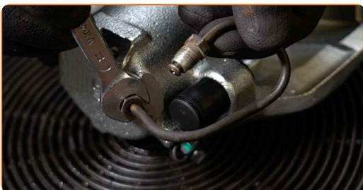
**24** Atornille las sujeciones del soporte del latiguillo de freno. Usa una llave mixta del n.º 10.
