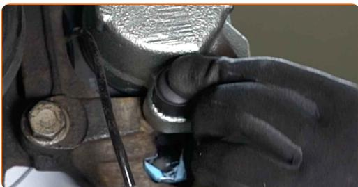
**28** Instale el clip de retención de la pastilla de freno. Use una palanca.
