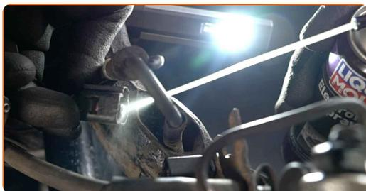
**32** Conecte el captador de desgaste de las pastillas de freno.
