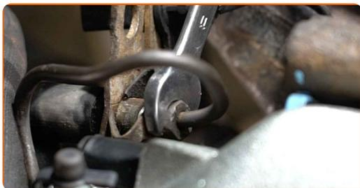
**31** Trate el enchufe del sensor de desgaste de las pastillas de freno. Utilice grasa dieléctrica.
