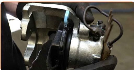
**26** Establezcan el soporte de freno y lo fijen. Use Vaso HEX No. H7. Utilice una llave dinamométrica. Apriételo a un par de 30 Nm.
