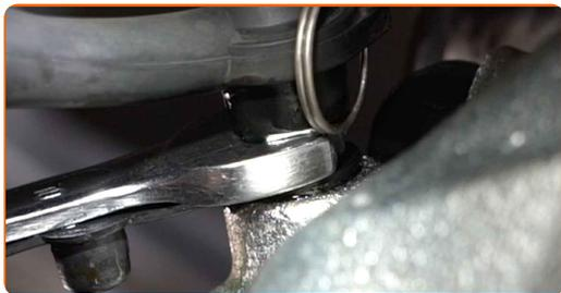
**39** Desconecte la manguera del kit de purgado de frenos.
