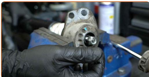
**21** Atornille la fijación superior de la varilla del amortiguador. Utilice un vaso para amortiguador DDNº6. Use un vaso de impacto del n.º 16. Utilice una llave dinamométrica. Apriételo a un par de 25 Nm.
