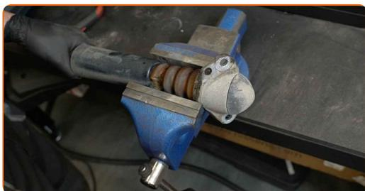
**16** Quite la tapa de protección del soporte del amortiguador. Use una palanca.
