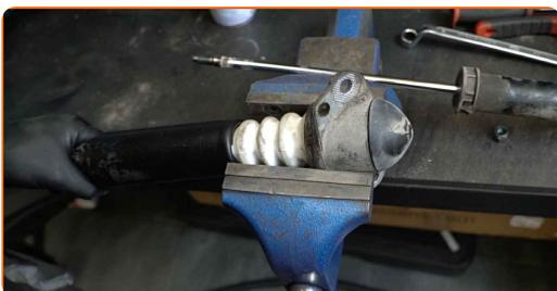
**25** Limpie los asientos de montaje del amortiguador. Use un cepillo de alambre. Use el aerosol WD-40.
