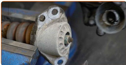
**17** Limpie la sujeción del vástago del amortiguador. Use un cepillo de alambre. Use el aerosol WD-40.
