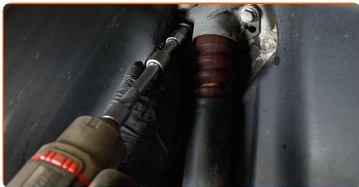
**12** Retire el perno de sujeción. Use un vaso de impacto del n.º 16. Utilice una llave de trinquete.
