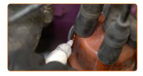
Desconecte los cables de la bujía de la tapa del distribuidor.
