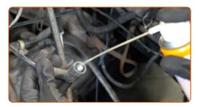
Conecte los cables de la bujía a la tapa del distribuidor.
